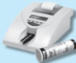
**Переносной анализатор мочи на 10 параметров CL-50** (НТИ, США), проводимые тесты: уробилиноген, билирубин, кетоны, эритроциты, белок, нитриты, лейкоциты, глюкоза, удельная плотность, pH, память 1000 результатов, встроенный принтер, 120 тестов в час.
