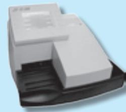
**Автоматический анализатор мочи на 11 параметров CL-500** (НТИ, США), проводимые тесты: уробилиноген, билирубин, кетоны, эритроциты, белок, нитриты, лейкоциты, глюкоза, удельная плотность, pH, аскорбиновая кислота, память 1000 результатов, встроенный принтер, 500 тестов в час.
